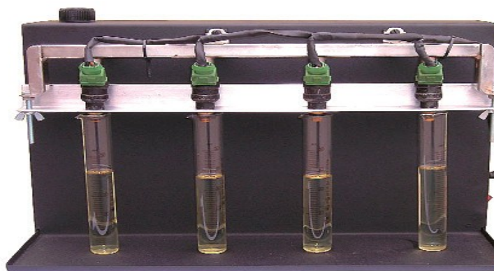
Рисунок 3.1 - Стенд для перевірки й очищення форсунок
