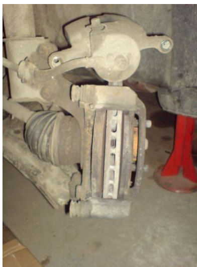
Рисунок 2.6 – Супорт на гальмівному диску
