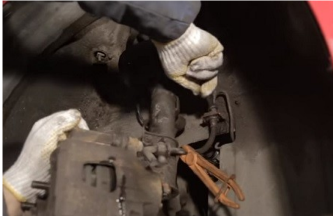
Рисунок 2.2 - Відгвинчування гайки кріплення гальмівної трубки до шланга
