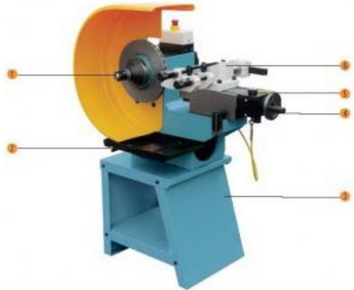
Рисунок 3.3 - Верстат для проточування гальмівних дисків і барабанів легкових автомобілів Comes Tornio TR450:
