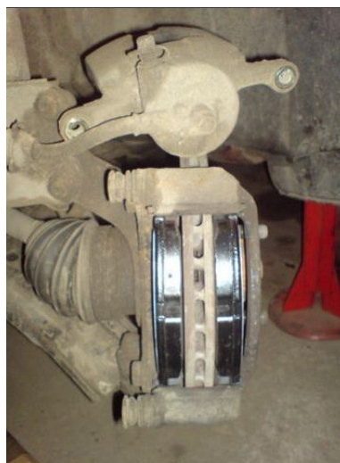
Рисунок 2.8 – Встановлені нові гальмівні колодки
