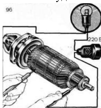
Рисунок 3.1 - Перевірка обмотки збудження на замикання з корпусом
