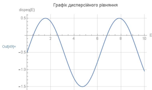
Рисунок 1.5 – Реалізація розв'язання дисперсійного рівняння методом стрільби мовою C++ з візуалізацією у Wolfram Mathematica
