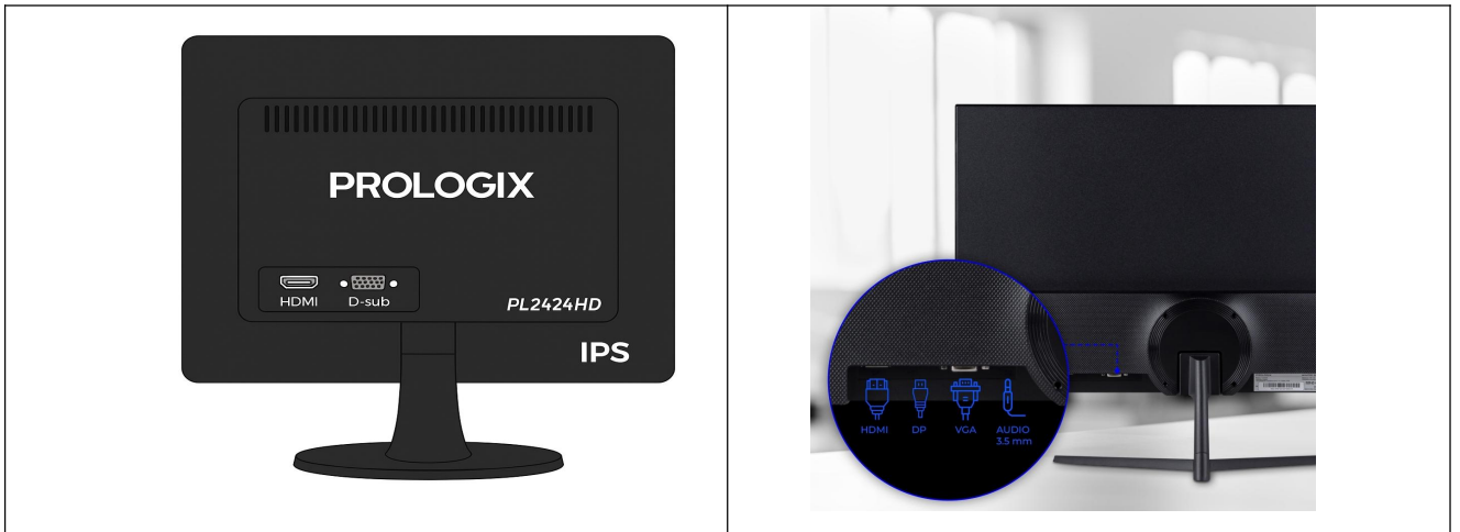
Рисунок 2.3 – Доступ до панелі роз'ємів
