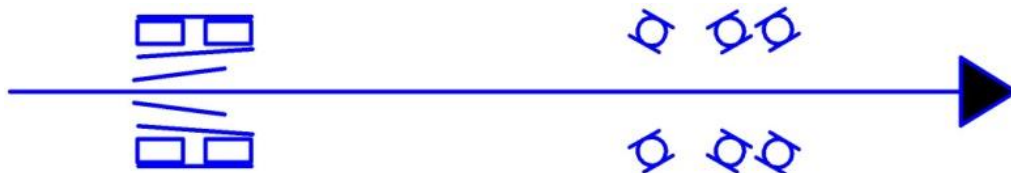
Рисунок 3.3 –Компонувальна схема шпиндельного вузла
