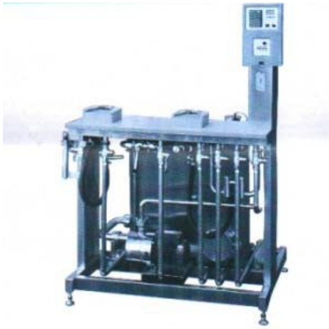
Рисунок 1.1.- Установка фасування в кеги типу Кег Сервіс 1М
