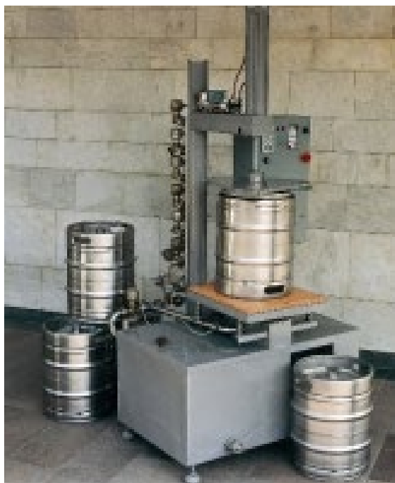
Рисунок 1.6.- Установка для чистки та миття кеїв типу КММ-1
