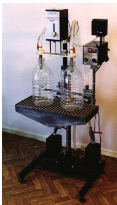
Рисунок 1.7.- Установка ДУЕТ для фасування рідких продуктів у об'ємну тару з наповненням по рівню.
