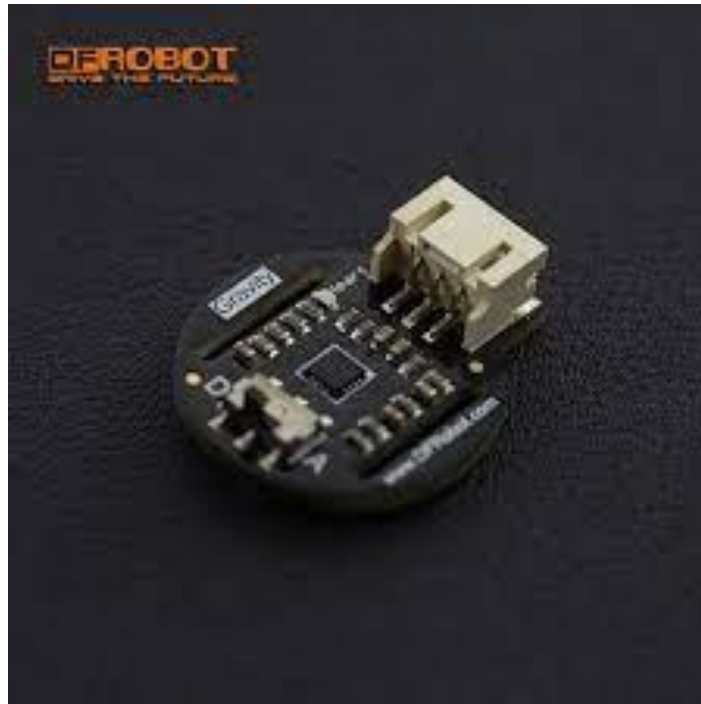
Рисунок 2.2 – PPG сенсор Arduino [1-9]
