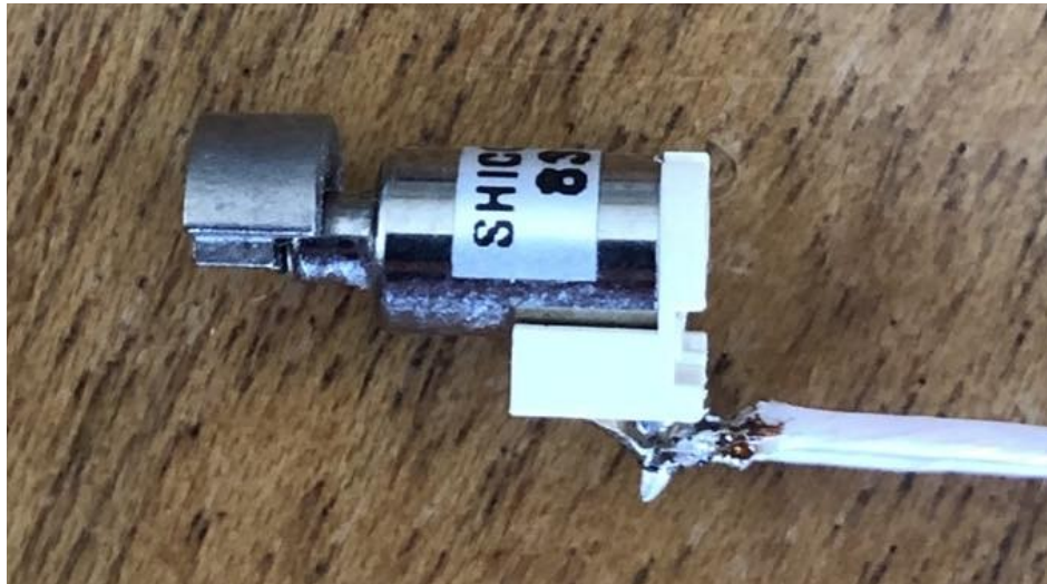
Рисунок 2.15 – Зовнішній вигляд використаного вібродвигуна
