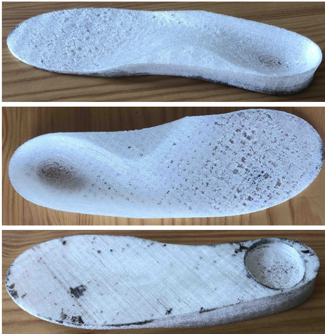
Рисунок 2.17 – Вигляд устілки із місцем під чутливий елемент
