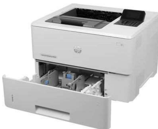
Рисунок 1.3 – Стандартний лоток принтера
