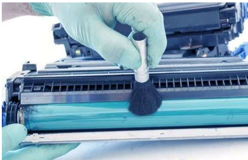
Рисунок 2.18 – Очистка проявочного вала
