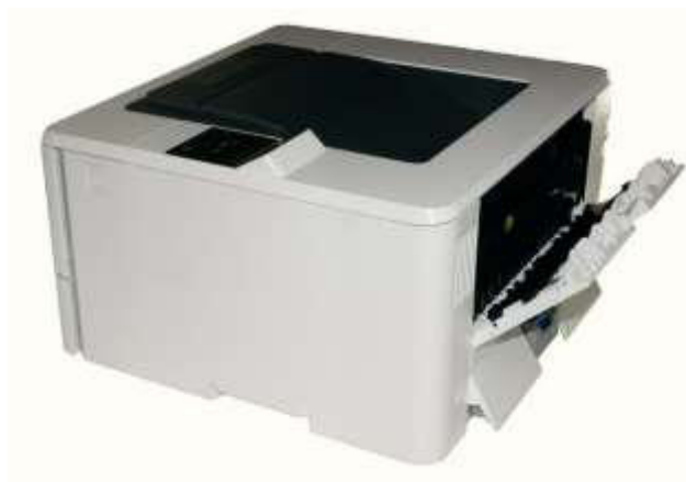
Рисунок 1.5 – Дуплексний механізм принтера
