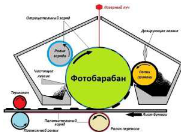
Рисунок 1.7 – Спрощена структура лазерного принтера
