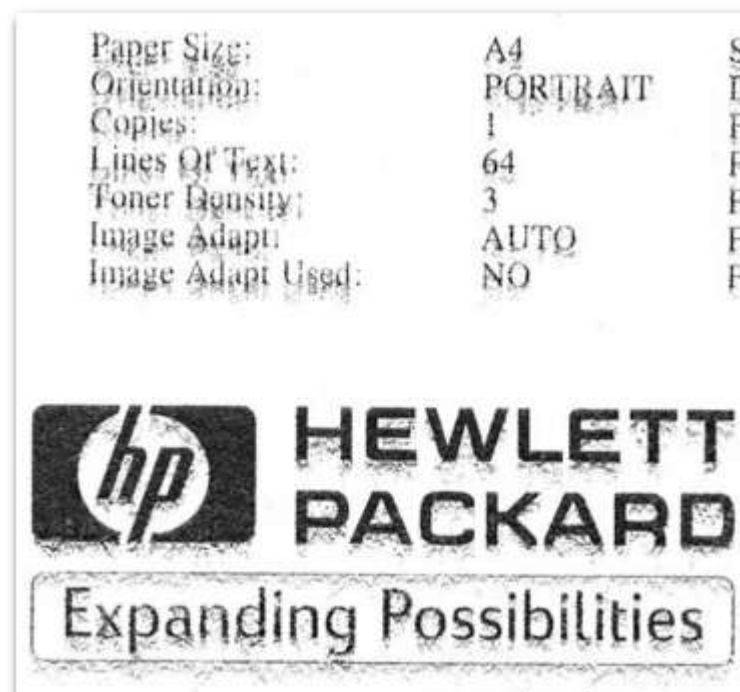
Рисунок 2.16 - Тестова сторінка при запиленні оптично-лазерної системи
