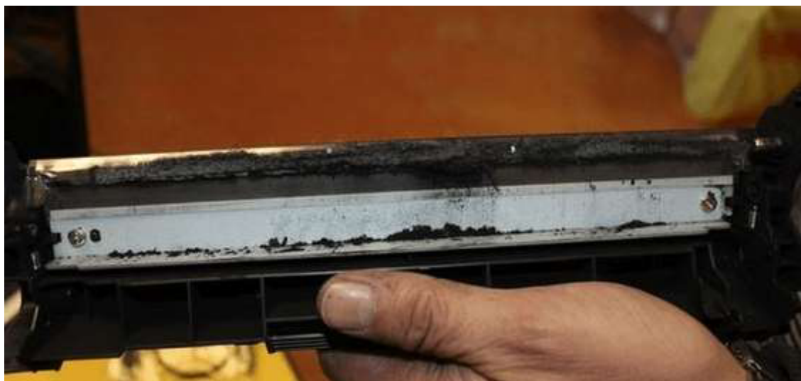
Рисунок 2.17 – Забруднене дозуюче лезо
