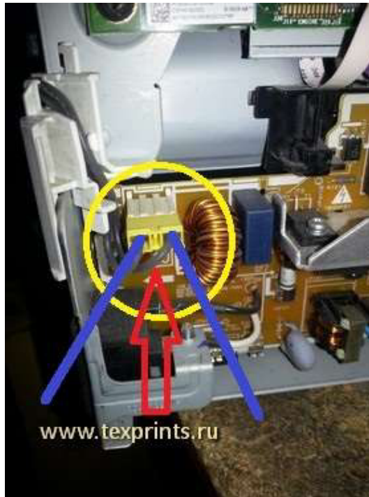
Рисунок 2.5 – Схема перевірки роз'єму ф'юзера
