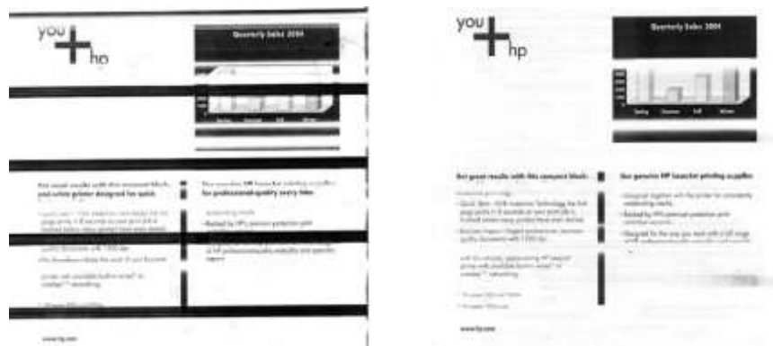
Рисунок 2.12 – Відновлення контакту зарядного ролика
