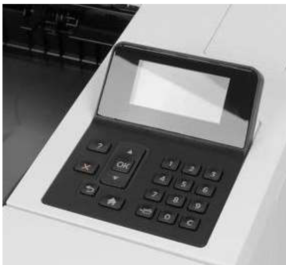
Рисунок 1.2 – Панель керування принтера HP LaserJet Enterprise M501dn
