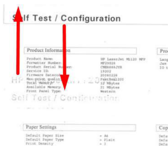
Рисунок 2.11 - Тестова сторінка при зношеному коротроні
