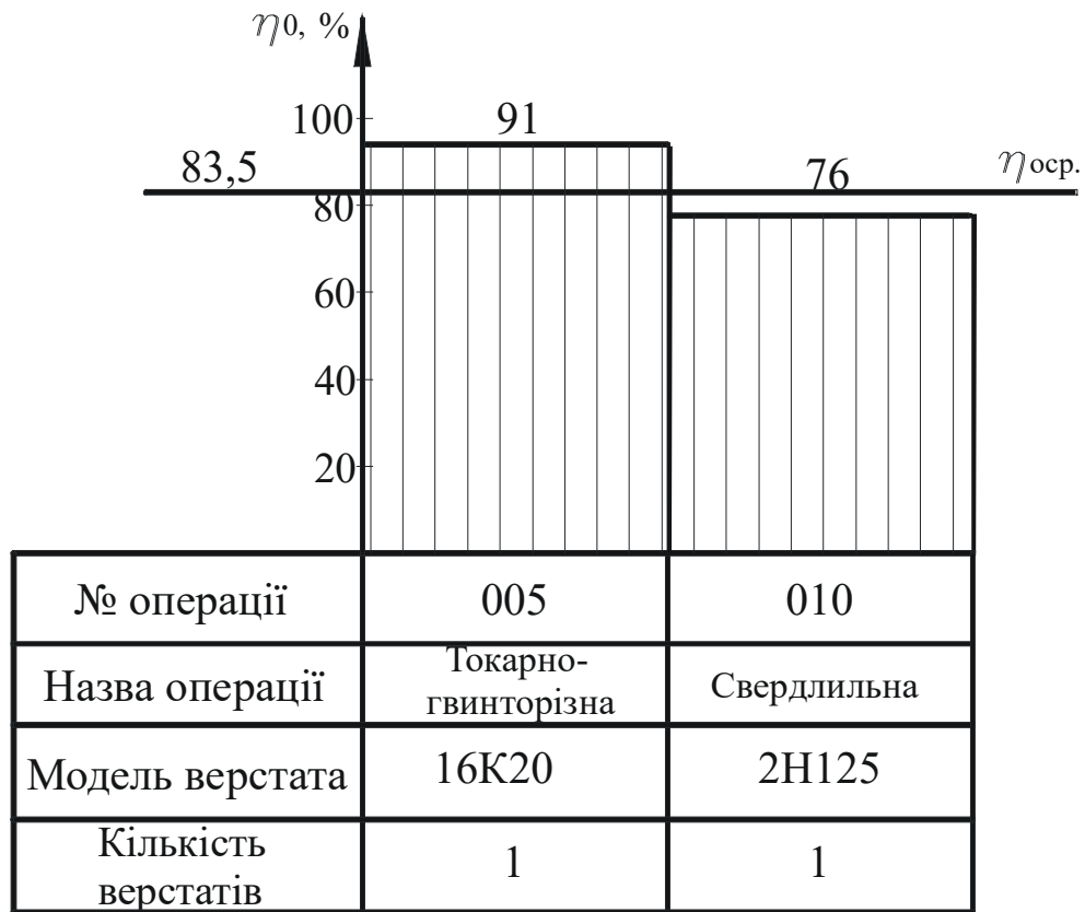
Рисунок 3.3. Графік завантаження обладнання по основному часу
