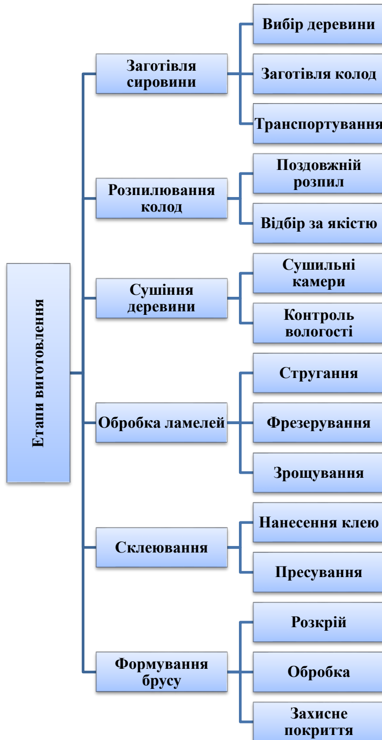
Рисунок 3.1 - Основні етапи виготовлення ламельного бруса
