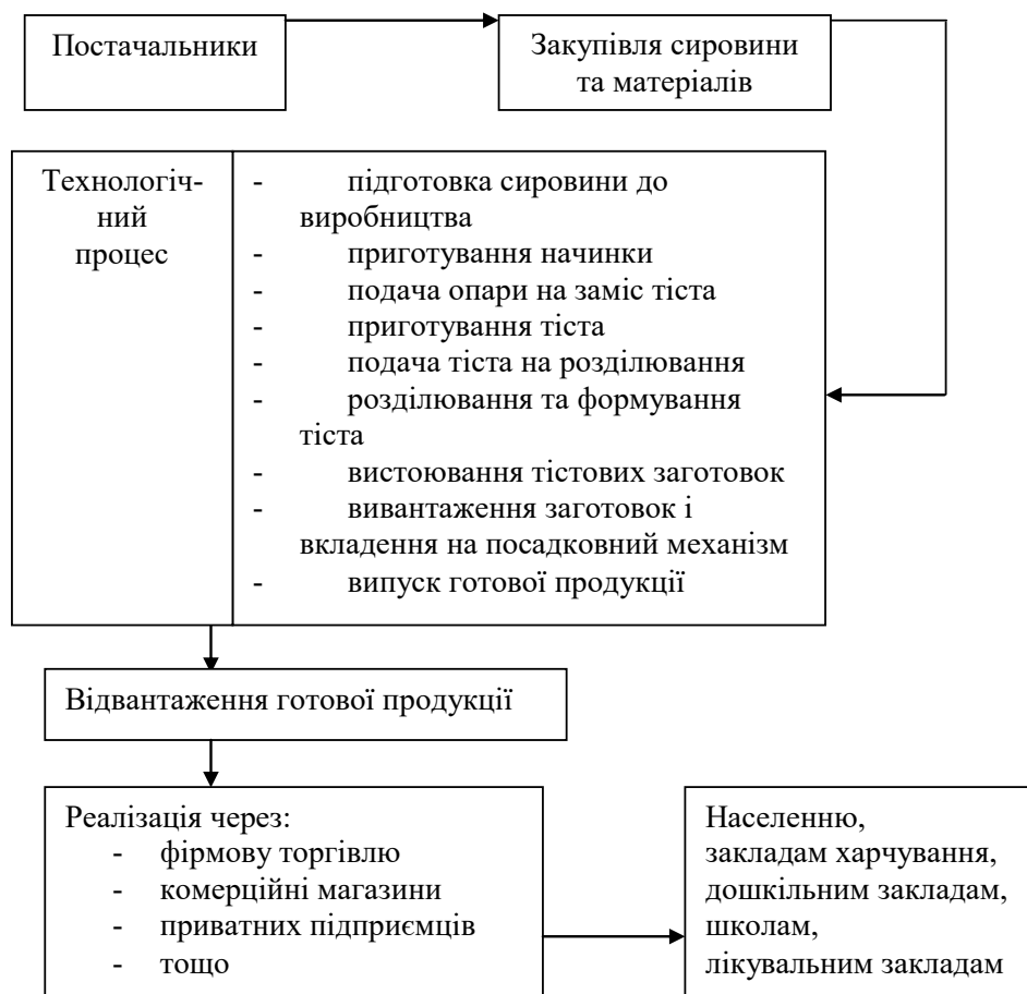
Рисунок 3.3 - Схема виробничих потоків виготовлення вареників і пельменів у ТОВ “Тернопільхлібпром”
