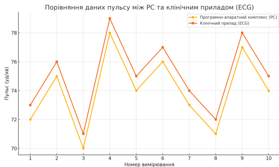
Рисунок 2.7 – Графік порівняння даних пульсу між програмно-апаратним комплексом (PC) та клінічним приладом (ECG)
