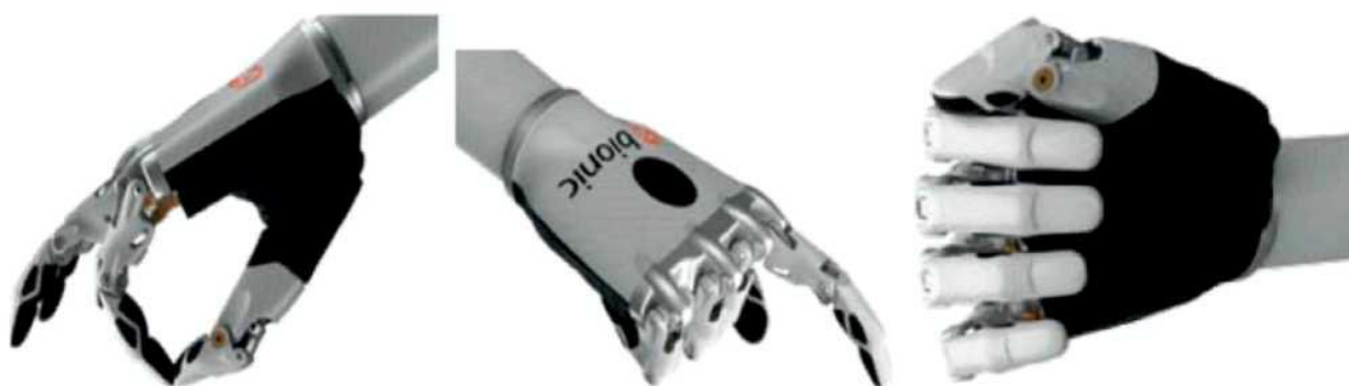
Рисунок 1.14 – Удосконалений протез Bebionic, розроблений Ottobock, дозволяє незалежно рухати кожним пальцем
