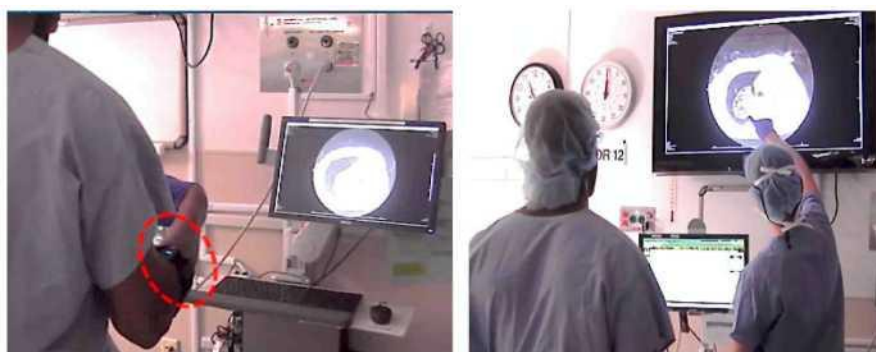
Рисунок 1.7 – Браслет Муо, що використовується в операційній кімнаті для керування камерою для візуалізації досліджуваної частини тіла, без необхідності фізично торкатися контролера чи медичного інструменту, що підвищує безпеку користувача та зменшує ризик інфекцій.
