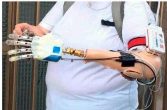
Рисунок 1.21 – Протез руки, що містить датчики та електроди, що дозволяють «відчувати» в режимі реального часу форму, шорсткість та консистенцію захоплених об'єктів.
