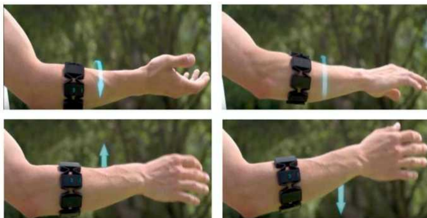
Рисунок 1.3 – Аналізуючи електричну активність м'язів передпліччя, браслет MYO виявляє рухи руки в кожному напрямку
