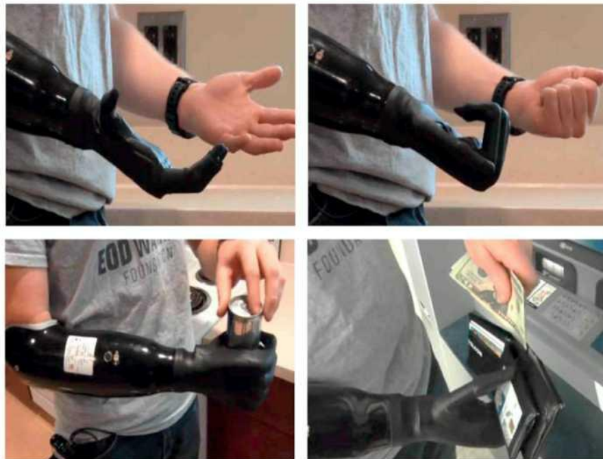
Рисунок 1.20 – Пацієнт з імплантованою системою IMES здатний виконувати численні рухи та завдання за допомогою протеза руки.
