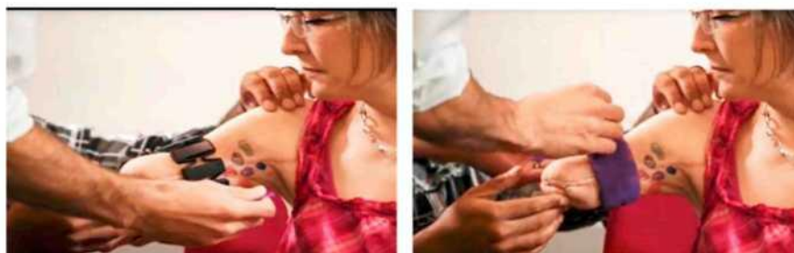
Рисунок 1.9 – Міо-браслет, який носить пацієнт; фіолетова пов'язка служить для кращого затягування браслета навколо руки.
