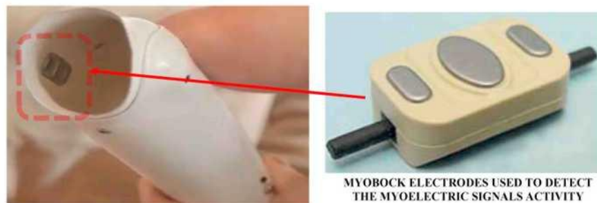
Рисунок 1.15 – Міоелектроди (MyoBock) від Ottobock, встановлені в гільзу протеза.
