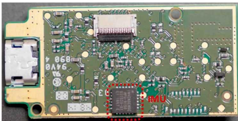
Рисунок 1.31 – Нижня сторона плати керування браслетом Муо: MPU-9150 IMU виділено червоним кольором.
