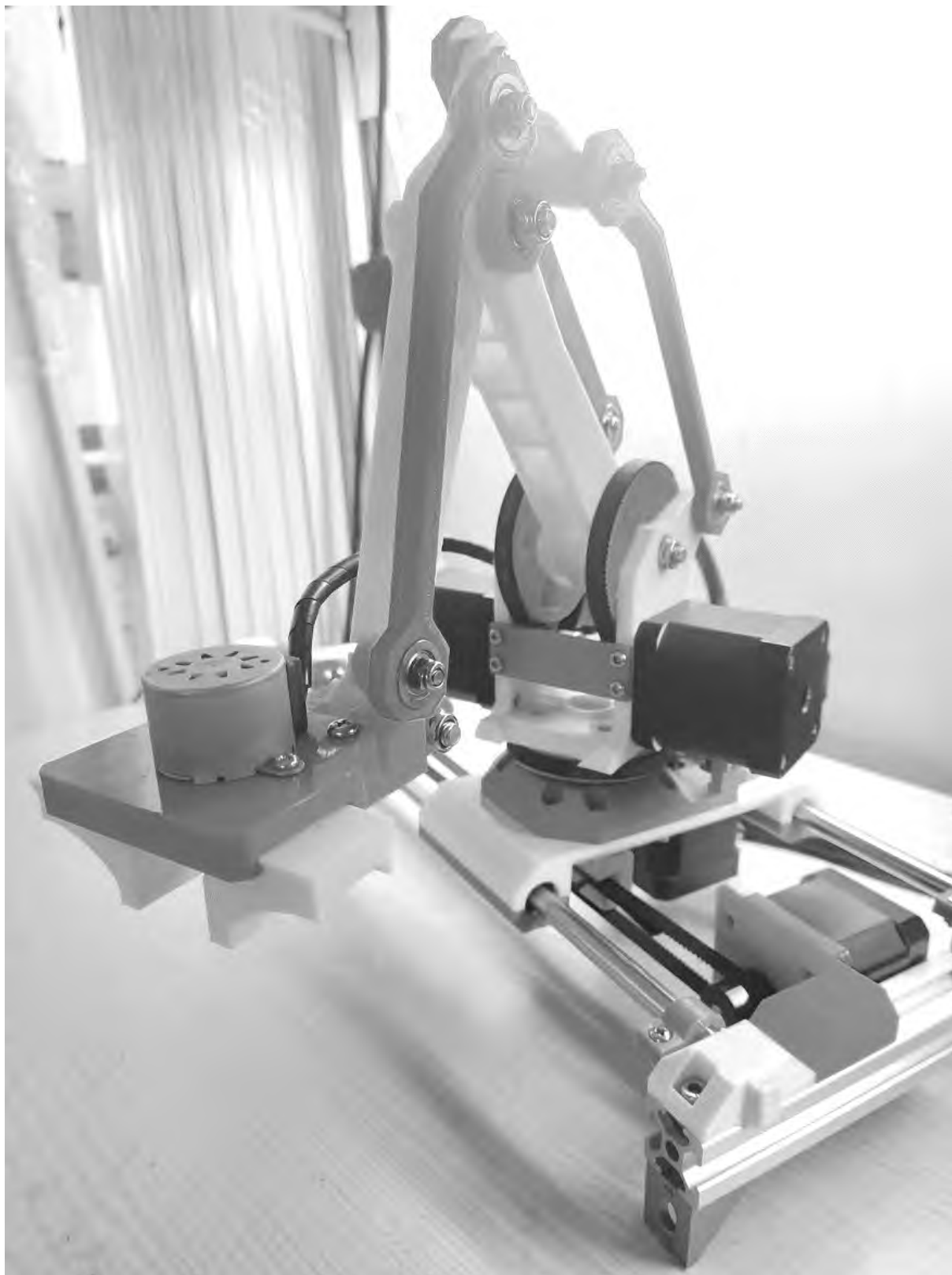
Рисунок 1.4 – Зовнішній вигляд удосконаленої конструкції маніпулятора
