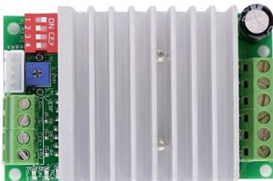
Рисунок 3.4 – Зовнішній вигляд драйвера TB6560AHG зверху
