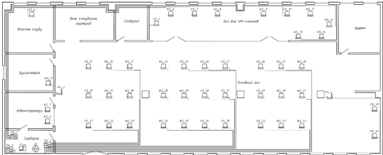
Рисунок 2.4 – Схема фізичного розташування кабелів та вузлів мережі комп'ютерного клубу “Сталкер”
