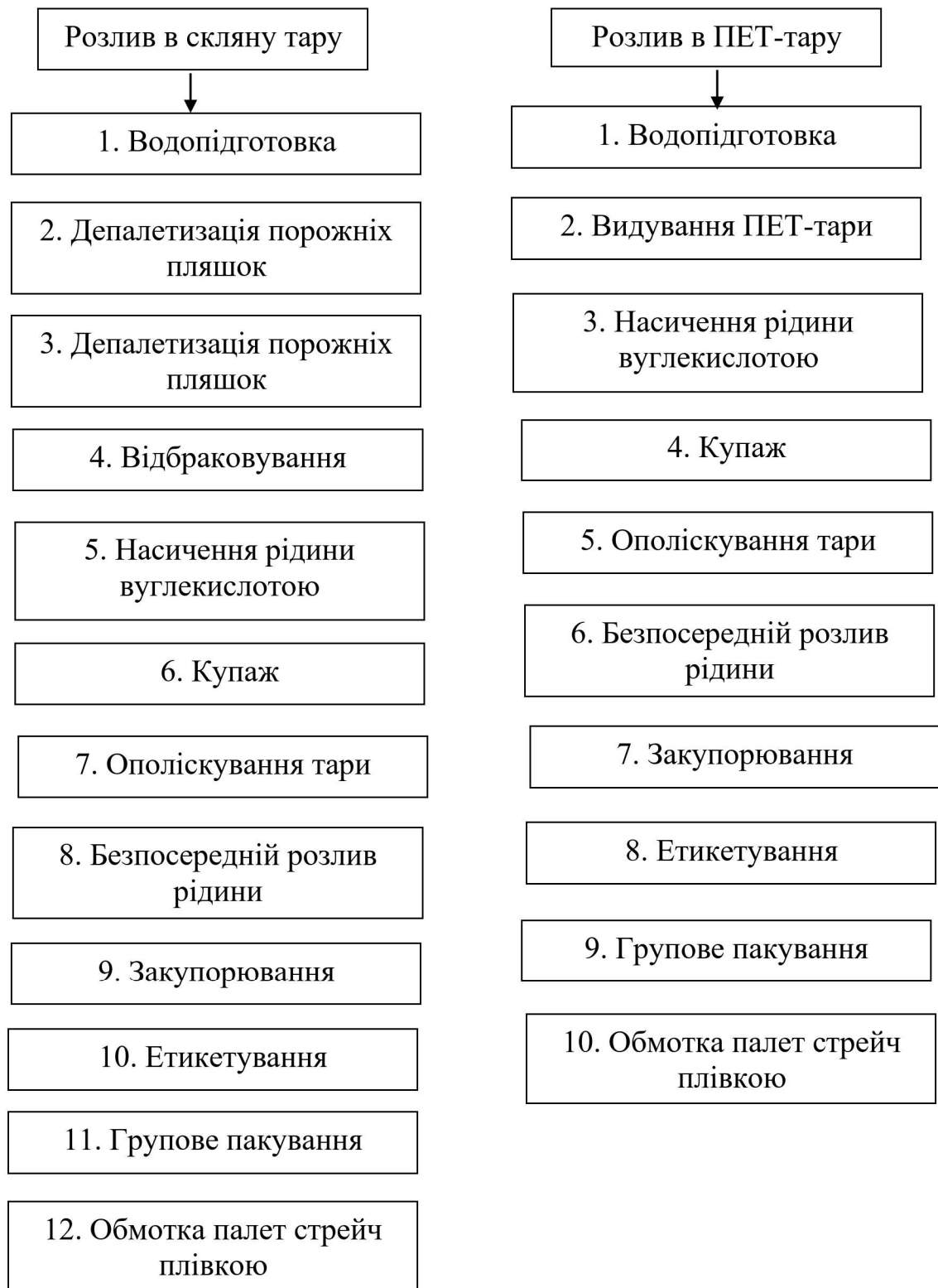
Рисунок 3.1 – Основні етапи повного виробничого циклу процесів лінії розливу у скляну та ПЕТ тари
