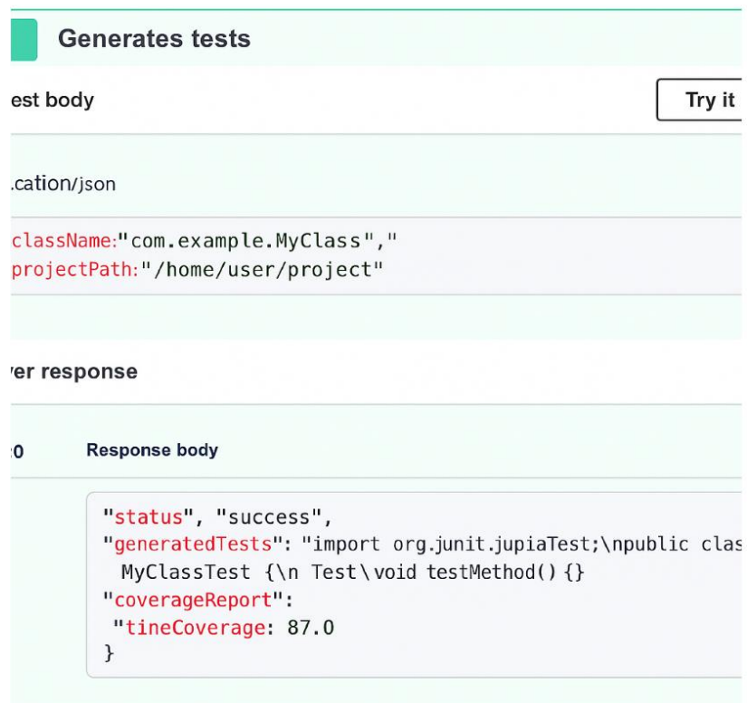
Рисунок 2.9 – Вебінтерфейс Swagger UI для ендпоінта генерації тестів
