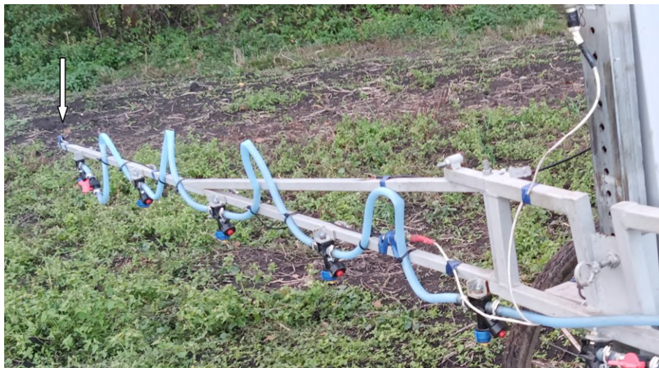
Рисунок 4.10 – Визначення прискорень на краю секції штанги
