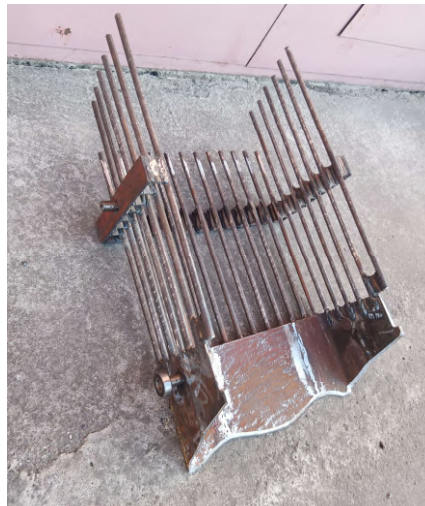
Рисунок 3.2 – Леміш картоплекопача (проміжна стадія виготовлення дослідного зразка)
