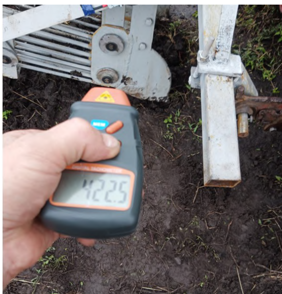
Рисунок 4.6 – Контроль і налагодження частоти обертання ВВП трактора
