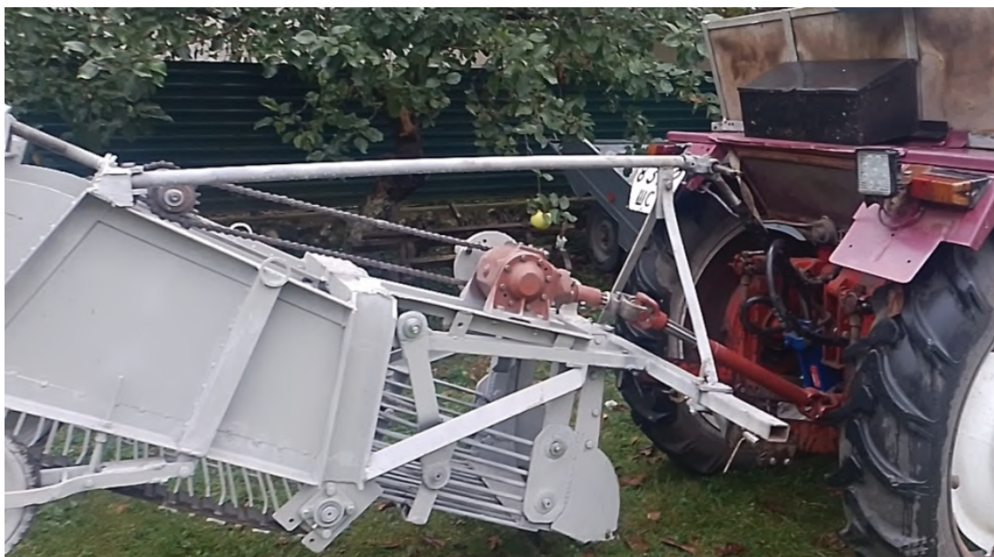
Рисунок 3.5 – Транспортне положення картоплекопача при навішуванні на триточкову навіску трактора
