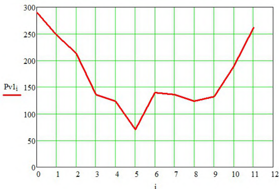
Рисунок 5.15 – Вертикальна складова опору переміщення лемеша
