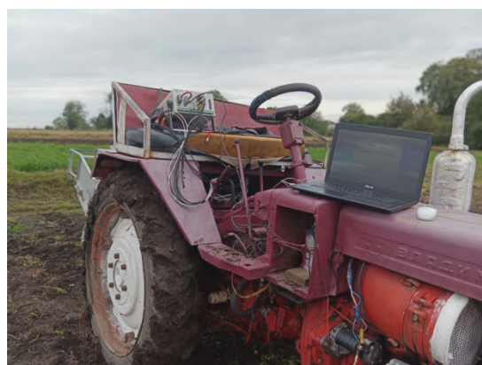
Рисунок 4.4 – Розміщення та підключення реєструючої апаратури
