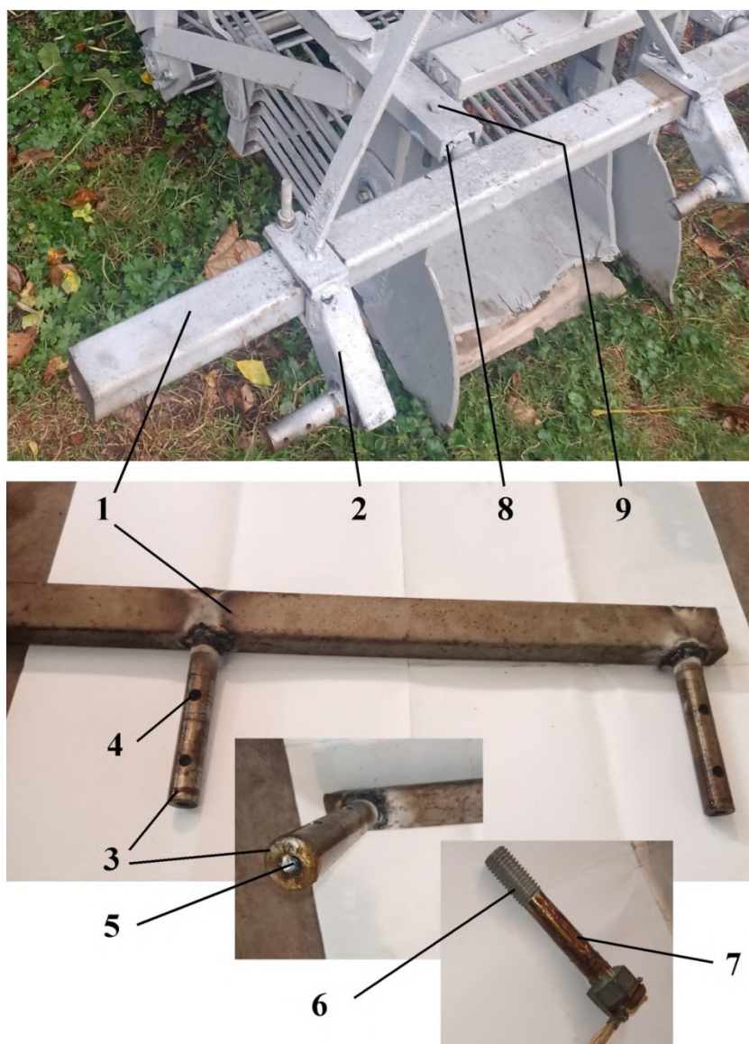
Рисунок 3.7 – Пристосування для визначення тягового опору картоплекопача
