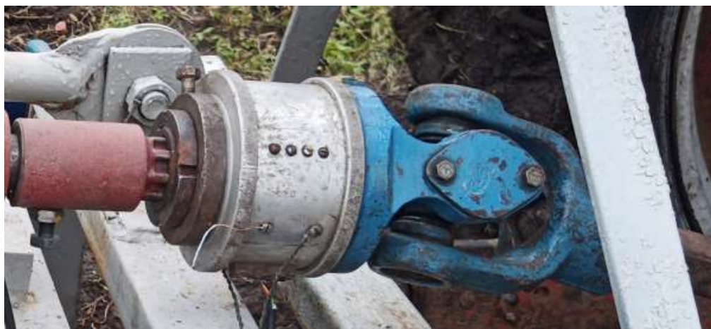
Рисунок 3.9 – Визначення крутного моменту приводу моментоміром
