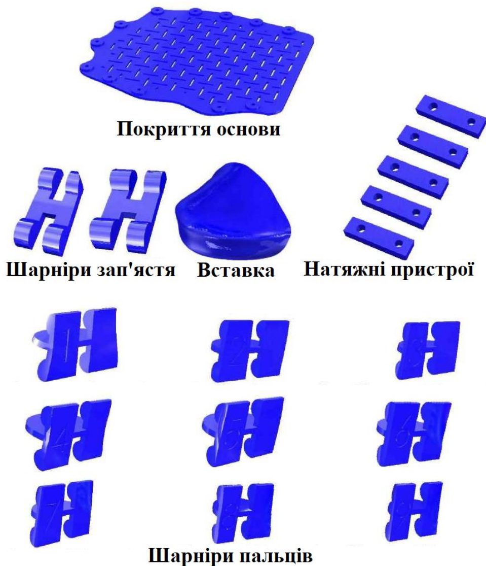
Рисунок 2.3 - Вигляд основних конструктивних елементів протеза Kinetic Hand, які виготовляються методом 3D друку із філамента TPU
