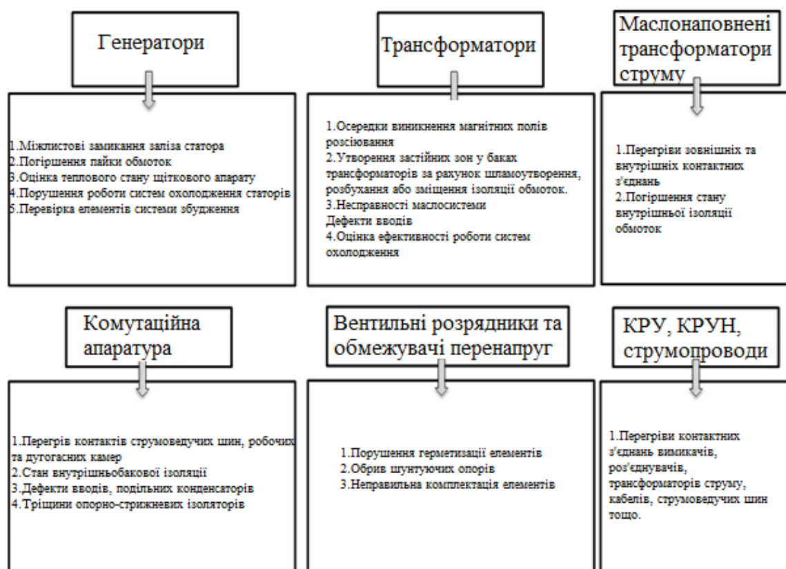
Рисунок 1.1 - Несправності електротехнічного обладнання
