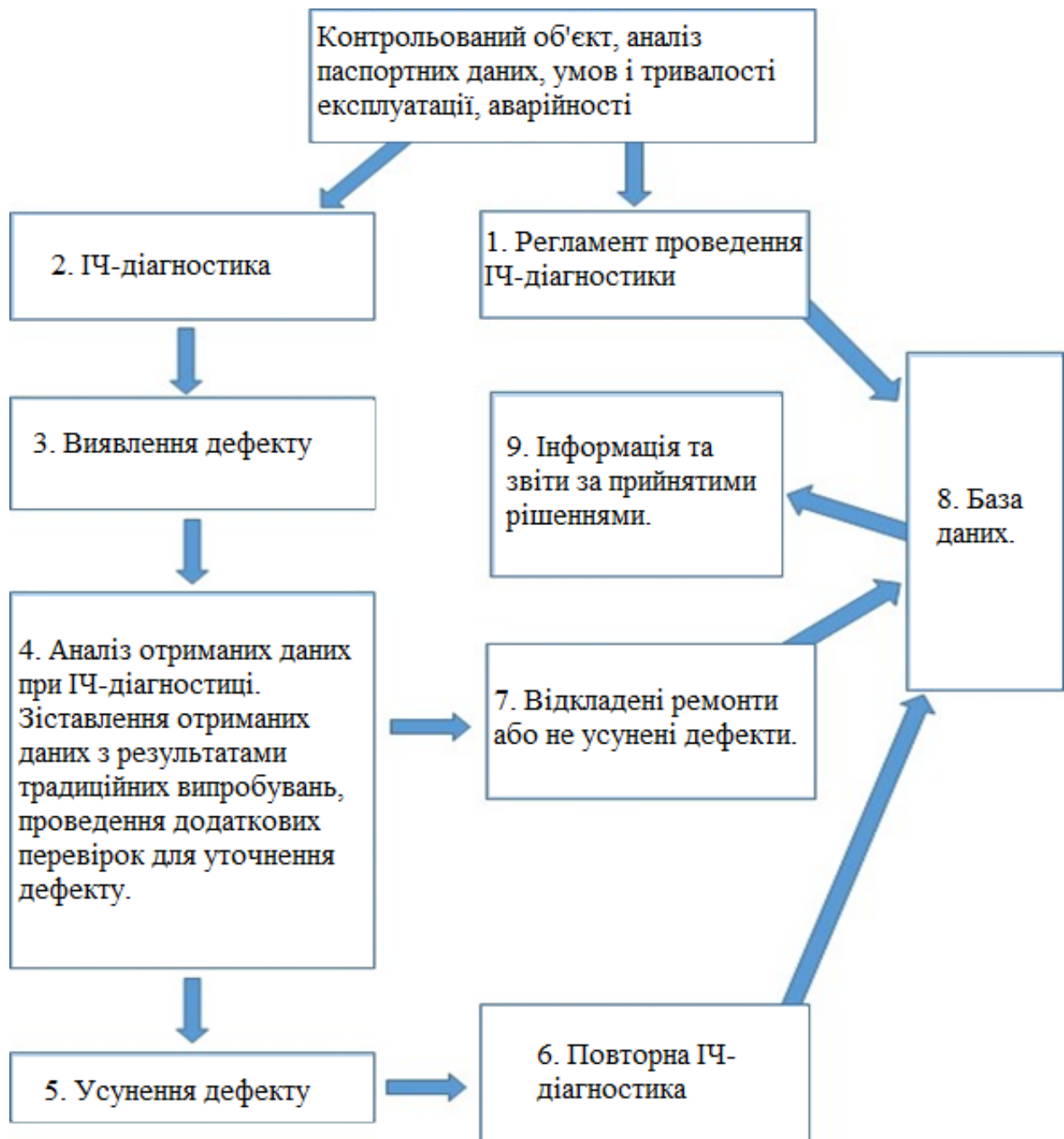
Рисунок 2.2 - Типовий алгоритм тепловізійної діагностики електротехнічного обладнання
