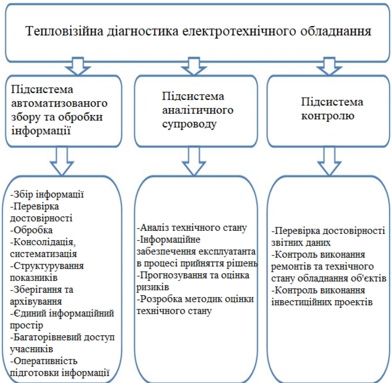
Рисунок 2.1 - Функції тепловізійної діагностики електротехнічного обладнання
