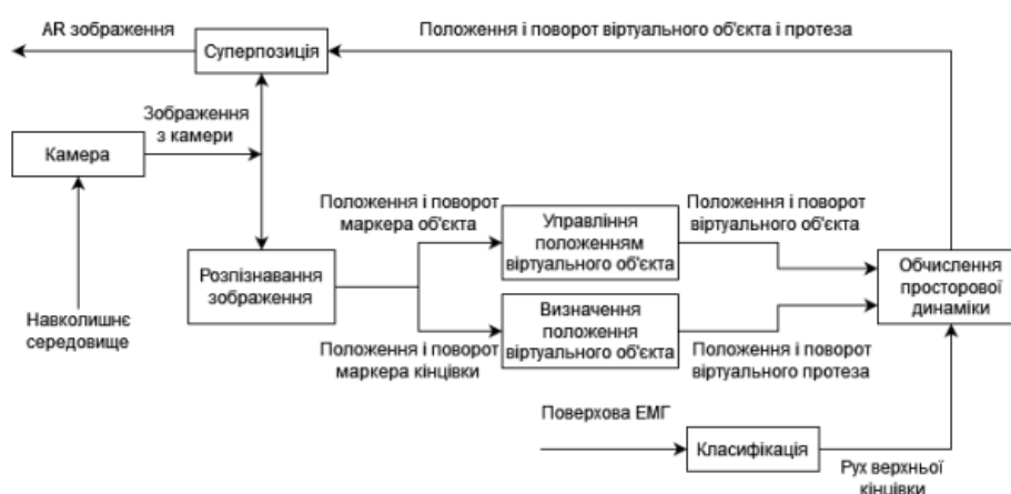
Рисунок 3.1 – Блок-схема технологій системи управління з великою кількістю ступенів рухливості протезу
