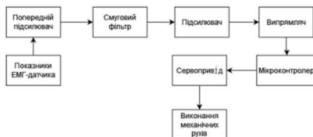
Рисунок 2.5 – Структурна схема блоку управління протезом кисті руки
