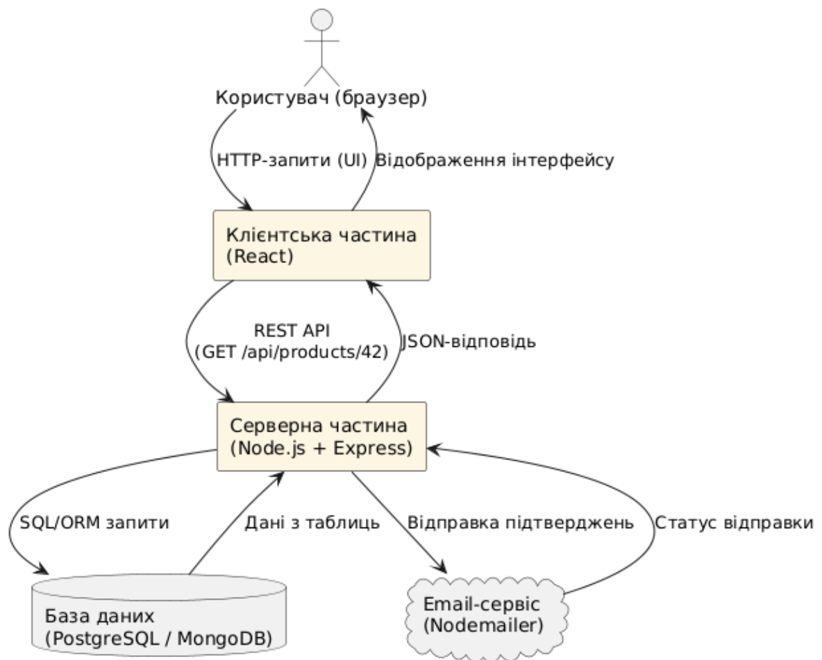
Рисунок 2.15 - Діаграма зв'язків серверної частини
