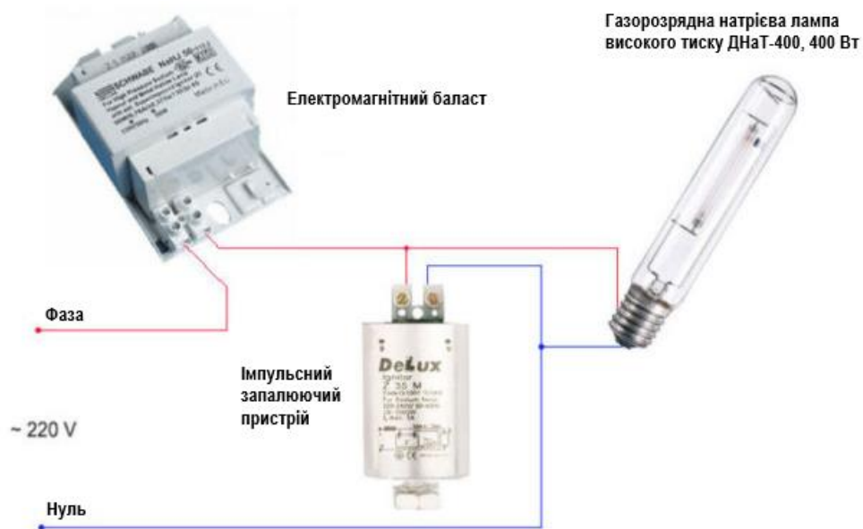
Рисунок 2.6 – Схема з імпульсним запалюючим пристроєм
