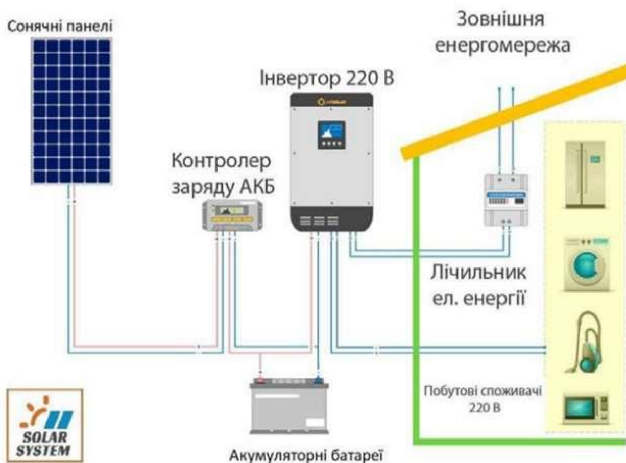
Рисунок 1.10 – Схема живлення побутових споживачів від сонячної панелі
