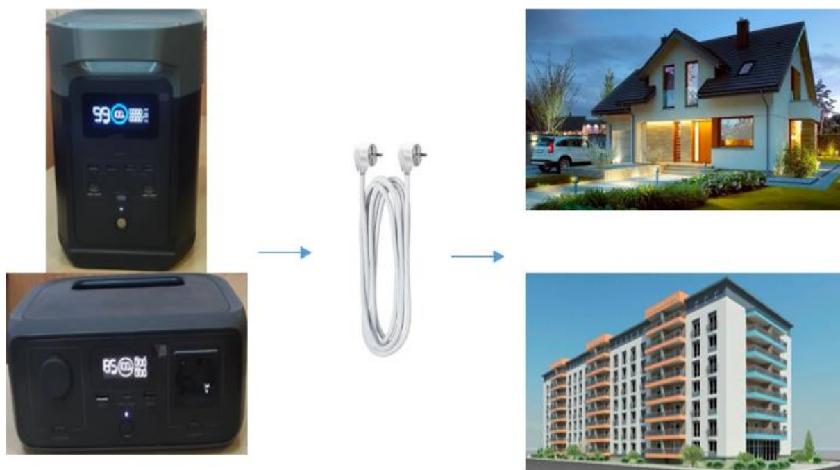
Рисунок 3.10 – живлення приватного будинку або квартири від зарядної станції через кабель з двосторонньою вилкою
