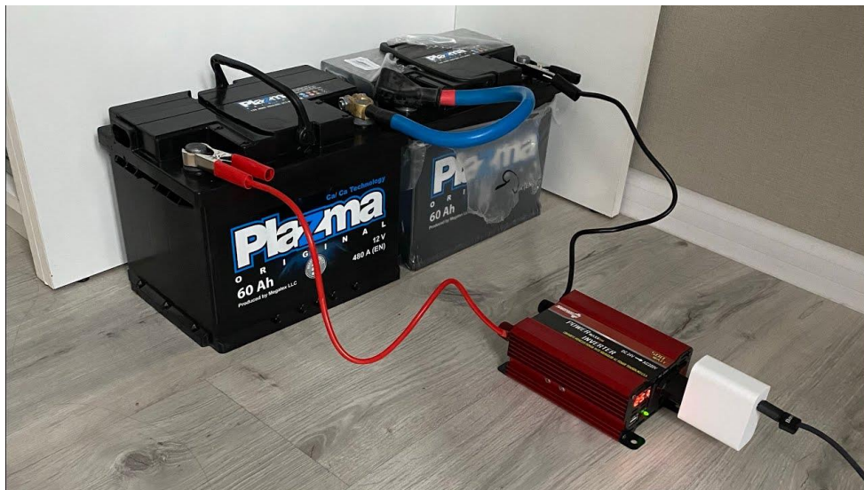
Рисунок 1.3 – Акумулятор “Plazma Original 6CT-60 A1” та інвертор “PowerOne Plus 24V-220V 500W”
