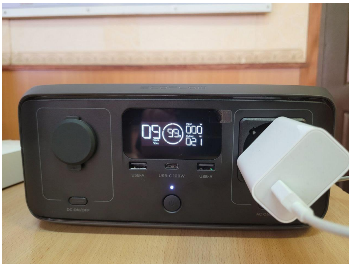
Рисунок 3.1 – EcoFlow River, фото дисплею при заряді практично 100% (99%) та підключеному навантаженні
