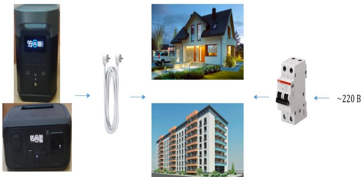
Рисунок 3.11 – живлення приватного будинку або квартири від зарядної станції через кабель з двосторонньою вилкою і з відключеним ввідним автоматом
