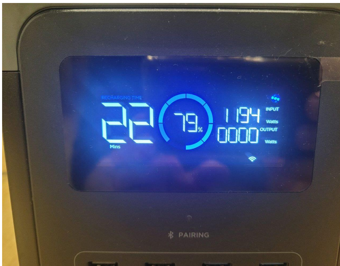
Рисунок 3.6 – Дисплей станції EcoFlow Delta в момент зарядки від електромережі
