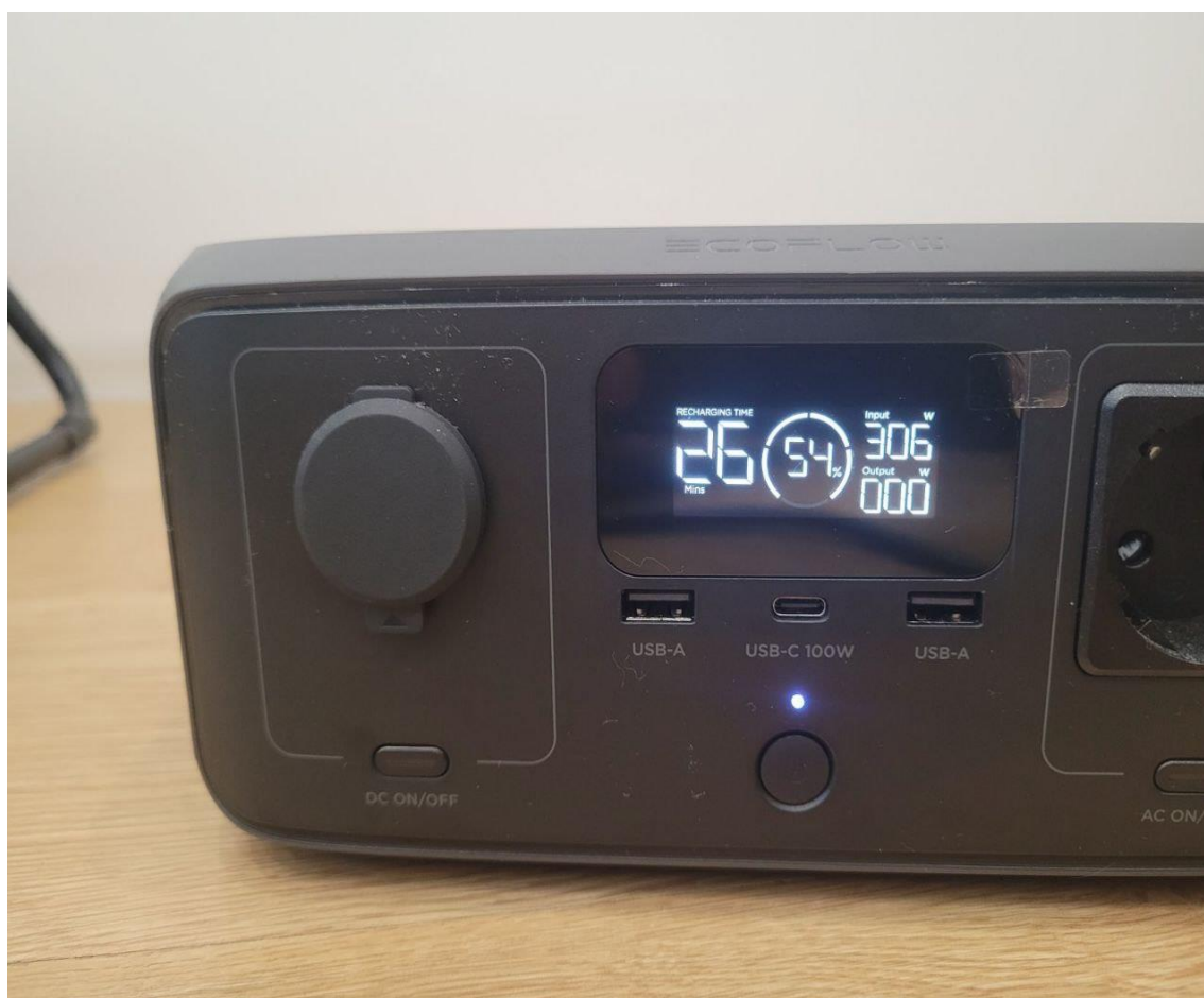
Рисунок 3.5 – Дисплей станції EcoFlow River в момент зарядки від електромережі
