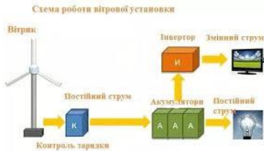
Рисунок 1.8 – Схема підключення вітрової установки до побутових приладів через інвертор та АКБ
