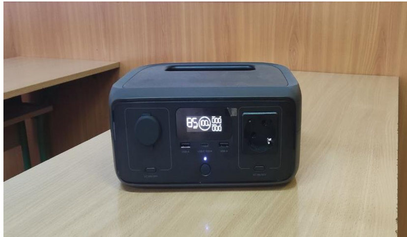
Рисунок 2.1 – Загальний вигляд портативної зарядної станції типу EcoFlow лінійки River (кафедра Електричної інженерії)
