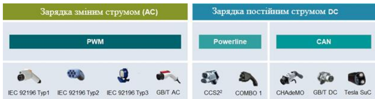
Рисунок 1.1 - Основні стандарти роз'ємів зарядки електромобілів
