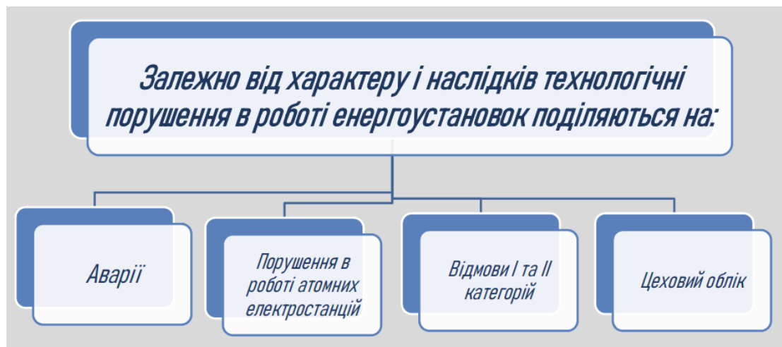
Рисунок 2.2. – Розподіл технологічних порушень в електромережах за характером
