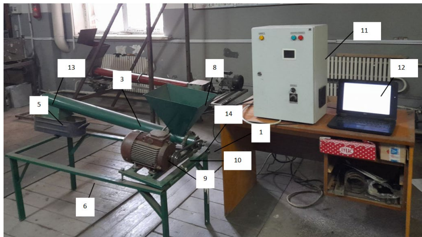
Рисунок 1- Експериментальна установка для дослідження характеристик гвинтових транспортерів-змішувачів конічної форми:
