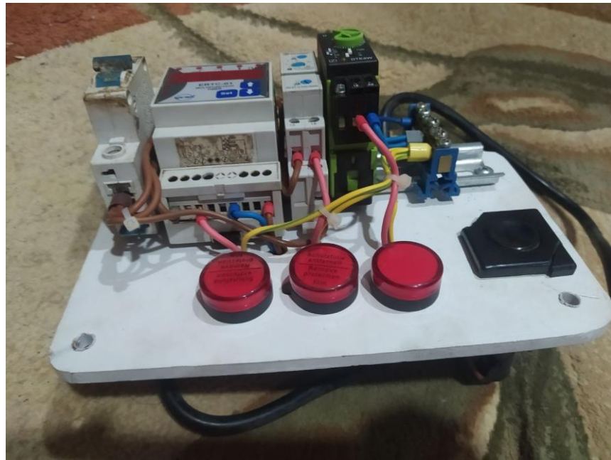
Рисунок 2.8- Вигляд схеми керування вуличного освітлення за допомогою реле часу знизу
