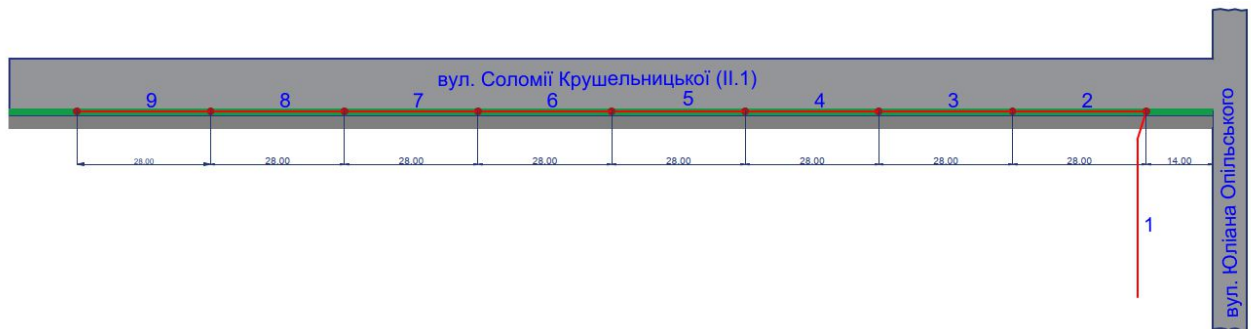
Рисунок 2.15 – Схема розміщення опор в системі освітлення смуги руху II.1 вулиці Соломії Крушельницької
