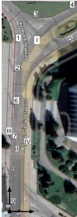
Рисунок 3.10 – Розміщення світильників в системі освітлення перехрестя
