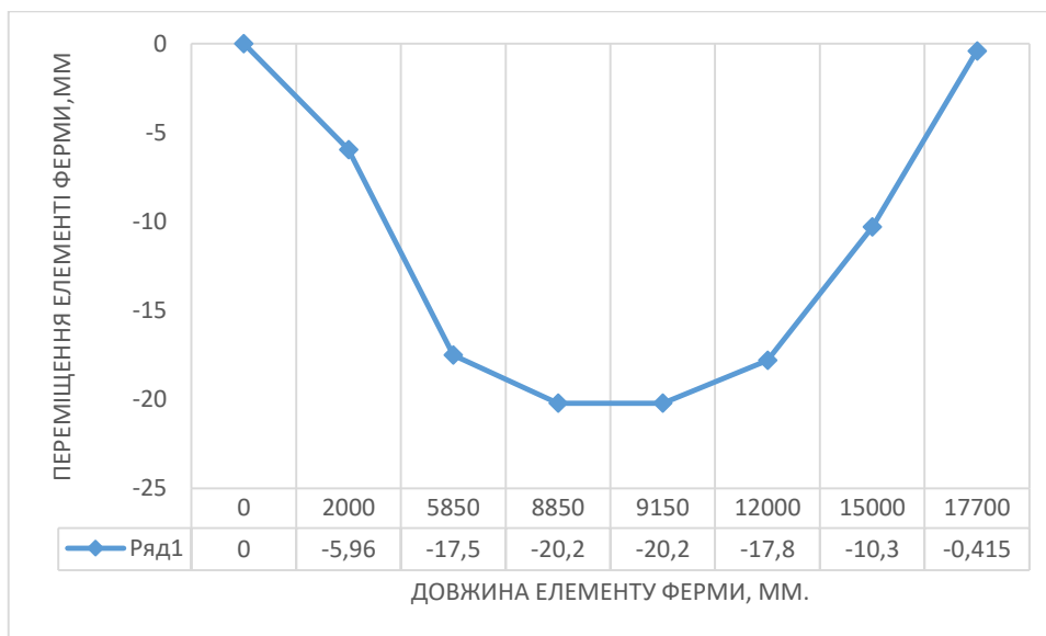
Рисунок 3.9 – Діаграма прогину верхнього поясу ферм від статичних навантажень
