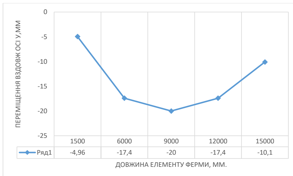
Рисунок 3.8 – Діаграма прогину в нижньому поясі ферм від статичних навантажень
