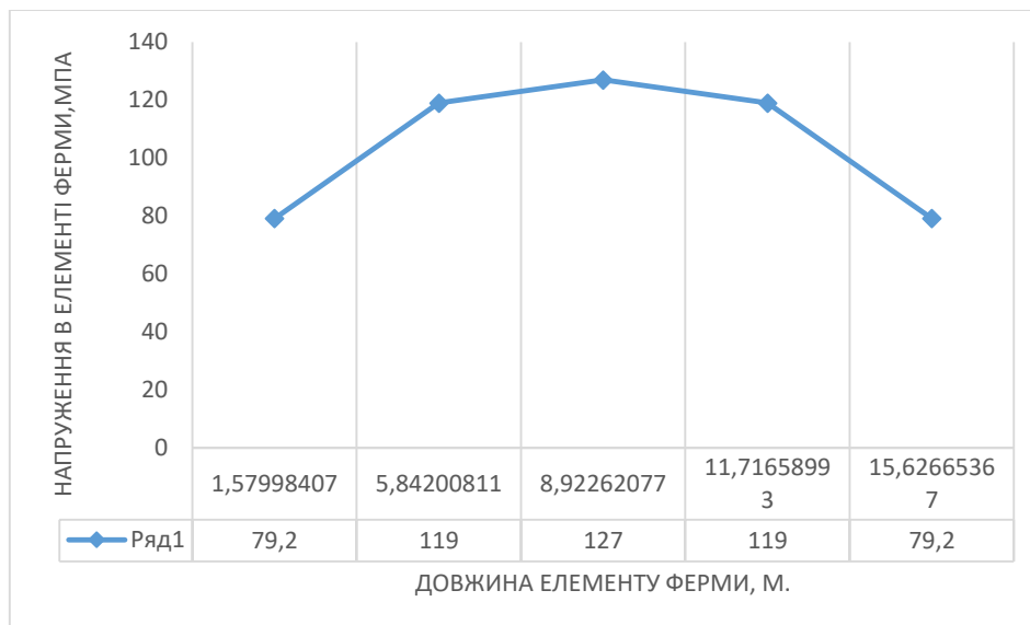
Рисунок 3.11 – Діаграма зміни напружень нижнього поясу ферми від статичних навантажень
