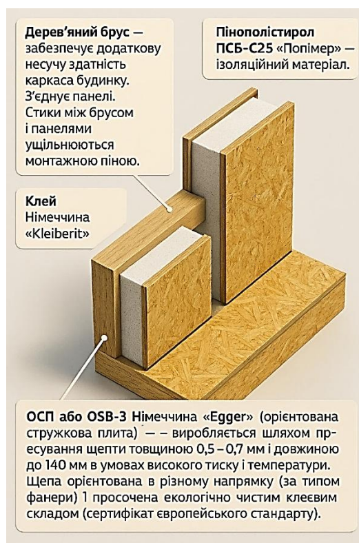
Рисунок 1.2 - Конструкція із СПП-панелей
