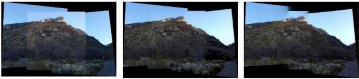
Рисунок 3.10 – Результати зшивання MOUNTAIN; лівий рисунок - без використання корекції кольору та змішування, центральний - з корекцією кольорів і альфа-змішенням, правий - з корекцією кольору і багатосмуговим змішуванням
