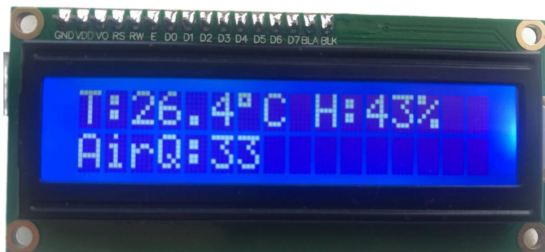
Рисунок 3.12 – Перевірка коректності прийому інформації з модуля приймача за допомогою рідкокристалічного дисплею
