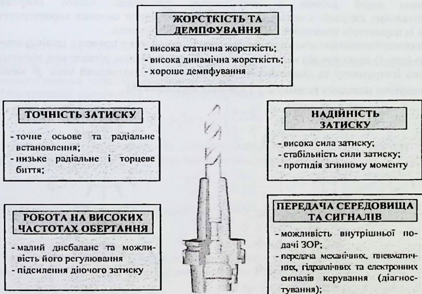
Рисунок 1 - Вимоги до конструкції інструментальних затискних патронів для високошвидкісної обробки.
