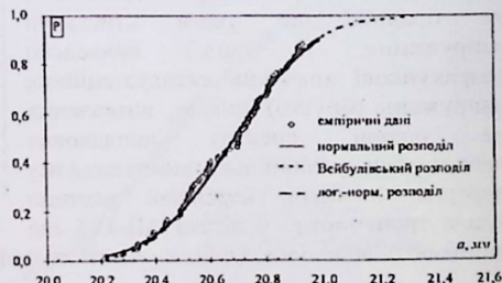
Рисунок 5 - Кумулятивні функції розподілу кінцевих довжин тріщин, моделювання за Уокером.
