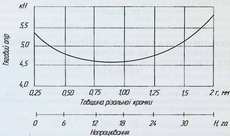
Рисунок 6 - Залежність тягового опору культиватора КПС-4 від товщини різальної кромки стрілочастих лоп і їх напрацювання.
