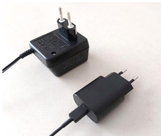
Рисунок 1.13 - Ілюстративне порівняння трансформатора-випрямляча 50 Гц (вгорі ліворуч) та напівпровідникового трансформатора (внизу праворуч)
