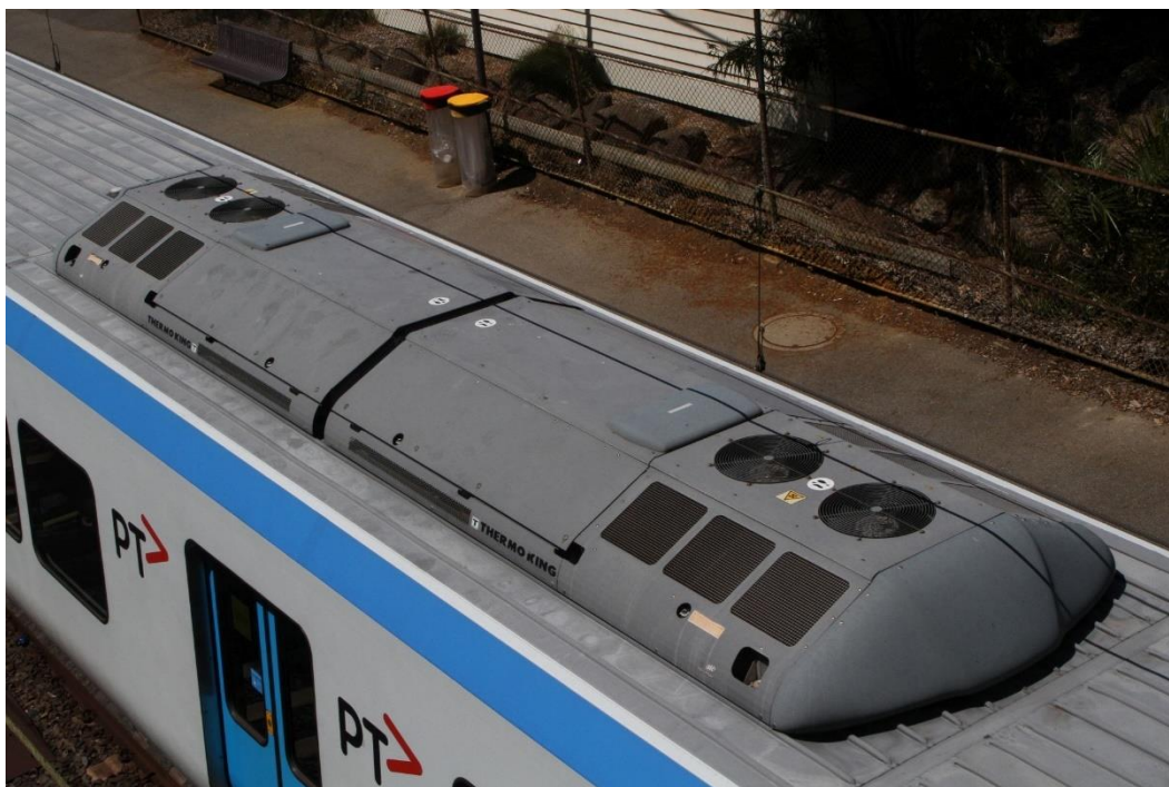
Рисунок 2.7 – Блок кондиціонера на даху потяга
