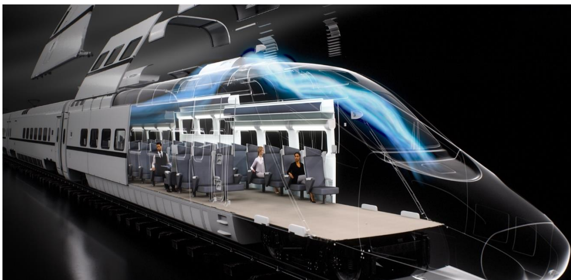
Рисунок 2.8 – Розподіл потоків кондиціонованого повітря у потязі
