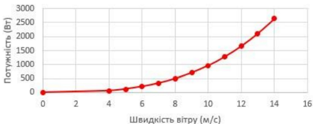
Рисунок 1.6 – Діаграма взаємозв'язку потужності енергетичної установки від швидкості вітру.
