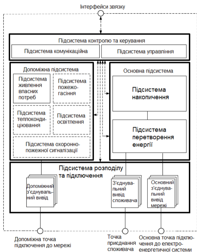
Рисунок 2.1 – Загальна структура системи накопичення енергії
