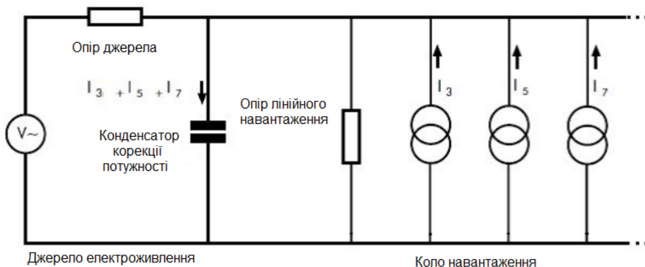
Рисунок 1.8 – Схема нелінійного навантаження з конденсатором корекції коефіцієнта потужності
