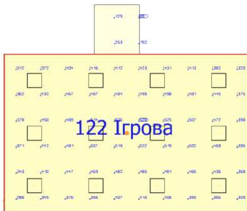
Рисунок 3.2 – Графік розподілу освітленості по поверхні підлоги приміщення ігрової від системи робочого освітлення
