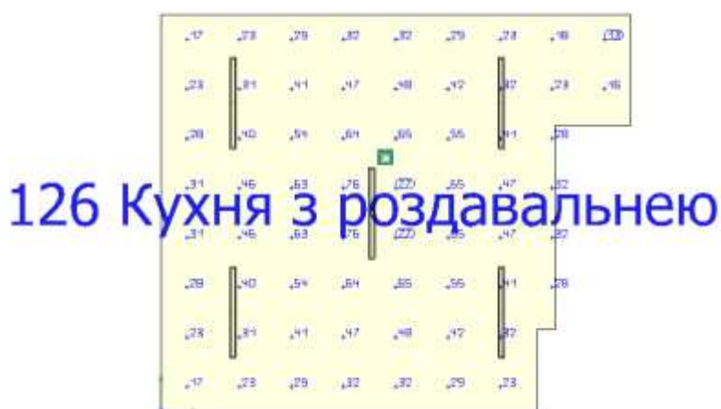
Рисунок 3.10 – Графіки розподілу освітленості по умовно робочій поверхні приміщення кухні з роздавальнею та мийною посуду від системи робочого (а) по поверхні підлоги від системи евакуаційного (б) освітлення
