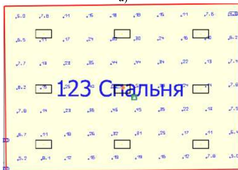
Рисунок 3.4 – Графіки розподілу освітленості по поверхні підлоги приміщення спальні від системи робочого (а) та системи евакуаційного (б) освітлення
