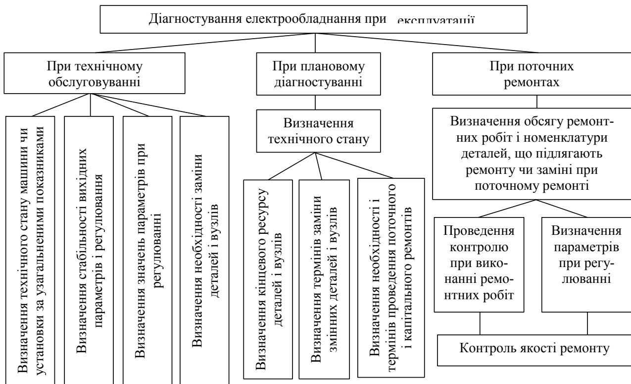
Рисунок 7.2 - Схема застосування методів і засобів діагностування електрообладнання
