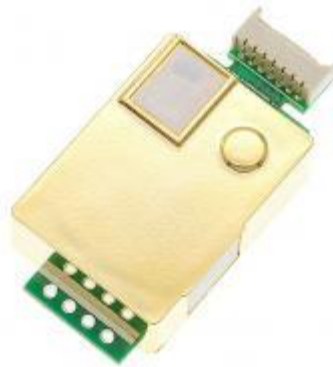
Рисунок 2.6 – Датчик рівня CO 2 МН-Z19
