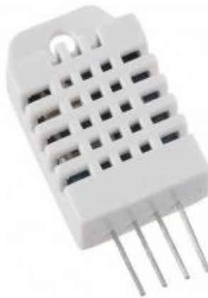
Рисунок 2.3 – Датчик температури DHT22
