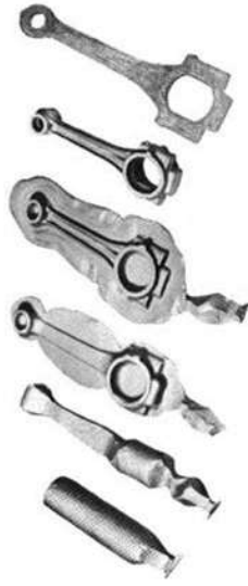
Рис.5.39 Етапи кування шатуна
